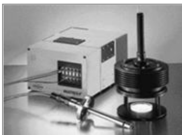
Figura 2. Espectrómetro Bruker Optics Matrix-F duplex equipado con una sonda de reflectancia difusa de fibra óptica para sólidos.
