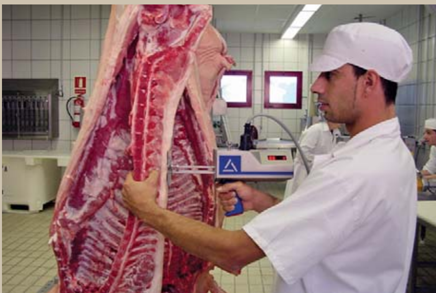
Figura 5. Medidas del espesor de grasa (GD F ) y músculo (PL F ) con el Fat-o-Meat'er.
